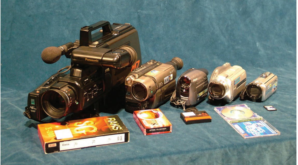
Fotoğraf 6.2: ABDÜLKADİR CANDEMİR. Örnek video kameralar. Soldan sağa (kayıt gereçlerine göre); VHS kaset, 8mm kaset, DV (digital video), yazılabilir disk ve bellek kartı üzerine kayıt yapabilen el kameraları.
